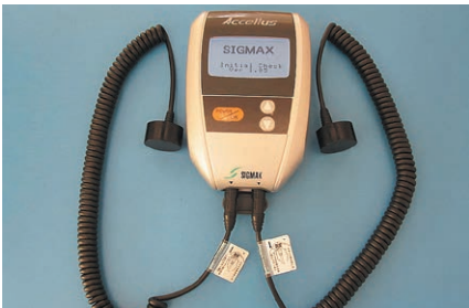
骨折部の治癒を促進する超音波骨折治療器
